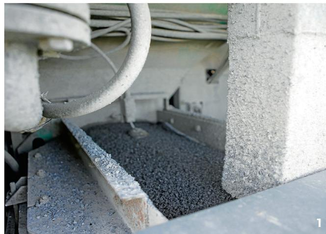
1 computergesteuerte Zufuhr der Zuschlagsstoffe über Bandwaage je nach Erfordernis | 2 Entnahme von Rückstellproben zur Qualitätssicherung | 3 hohe Tagesleistungen durch modernen DSK-AIR-Einbauzug
