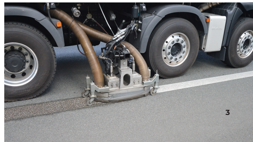
1 Computersteuerung im Fahrerhaus | 2 Einsatz der Heckcleaner | 3 Einsatz des Seitencleaners
